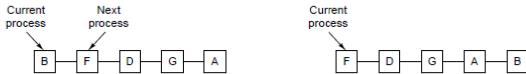
图2-22 时间片轮转调度。a) 就绪进程列表。(b) 进程B用完它的时间片后的就绪进程列表。
