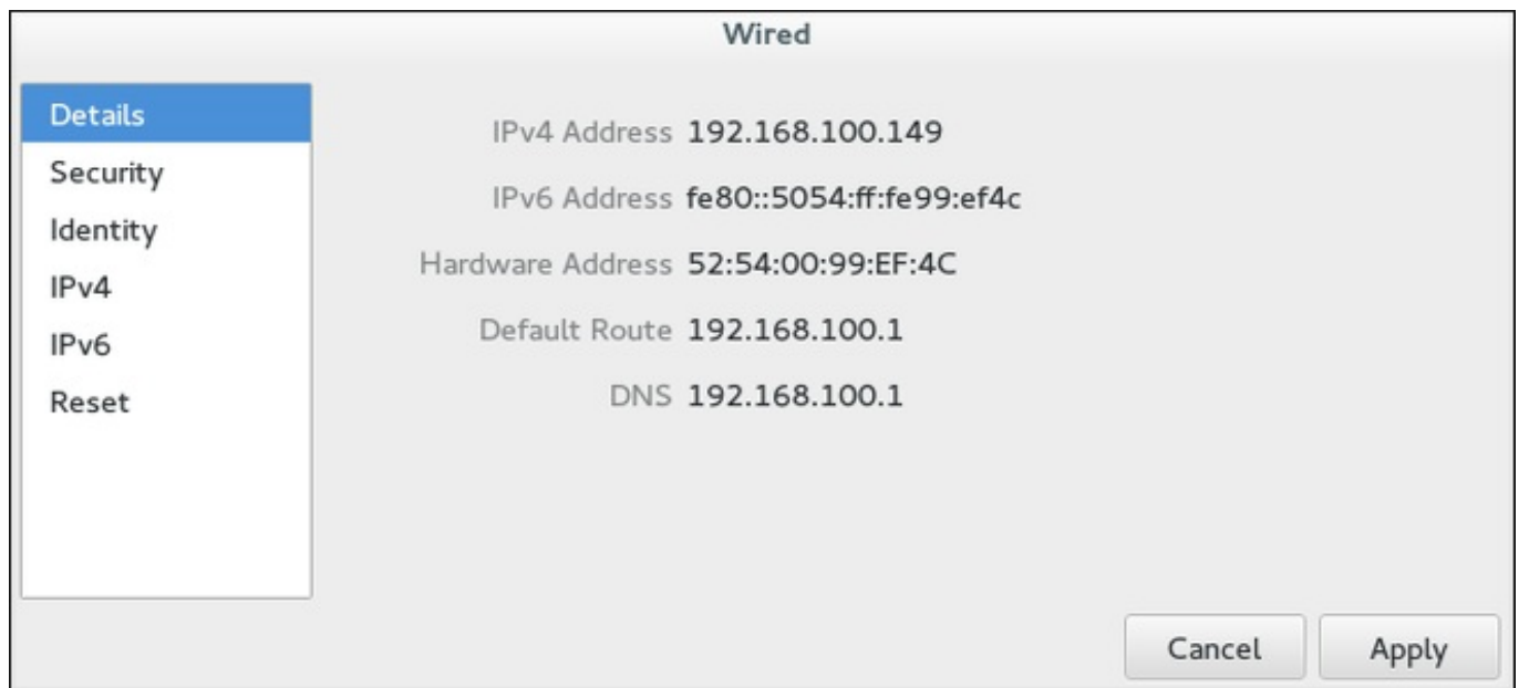
図2.5 ネットワーク接続詳細ウィンドウを使用したネットワークの設定
