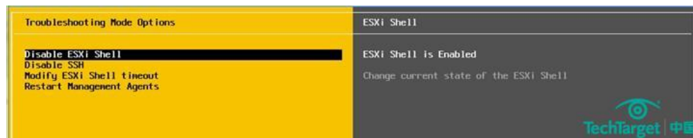
图 2. 在 ESXi 主机控制台下禁用 ESXi Shell
