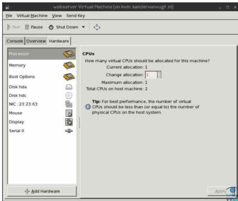
图 2: libvirt 接口是默认的用于 Red Hat Enterprise Virtualization 虚拟机的管理技术
