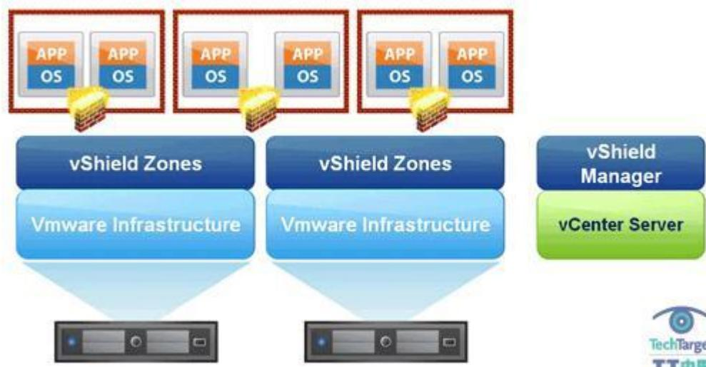
VMware 通过部署 vShield Zones 使用核心产品 实现对虚拟网络的基本保护功能。vShield Zones 提供的网络防护和分析功能与很多第三方的程序类似。如：Reflex Systems Virtualization Management Center、Altair Networks Virtual Firewall 和 Catbird 的 V-Security。但是相比而言 vShield Zones 没有那么复杂，是一个简化版的产品。简化的好处就是 VMware 的管理员会发现 vShield Zones 使用起来非常方便。用户无
