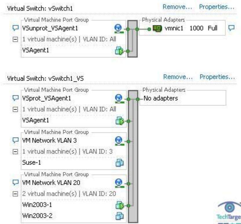
从图上可以看到所有的流量必须通过位于 vSwitch1 上的物理网卡，然后穿过 vShield agent 虚拟机，到达新的虚拟机所在的被保护的 vSwitch1\_VS vSwitch。
